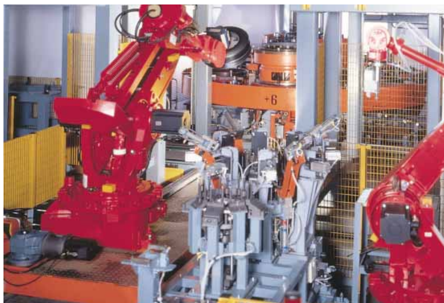
Bei der MIRS-Produktionsmethode von Pirelli steuern ausschließlich Computer und Roboter die Reifenfertigung
