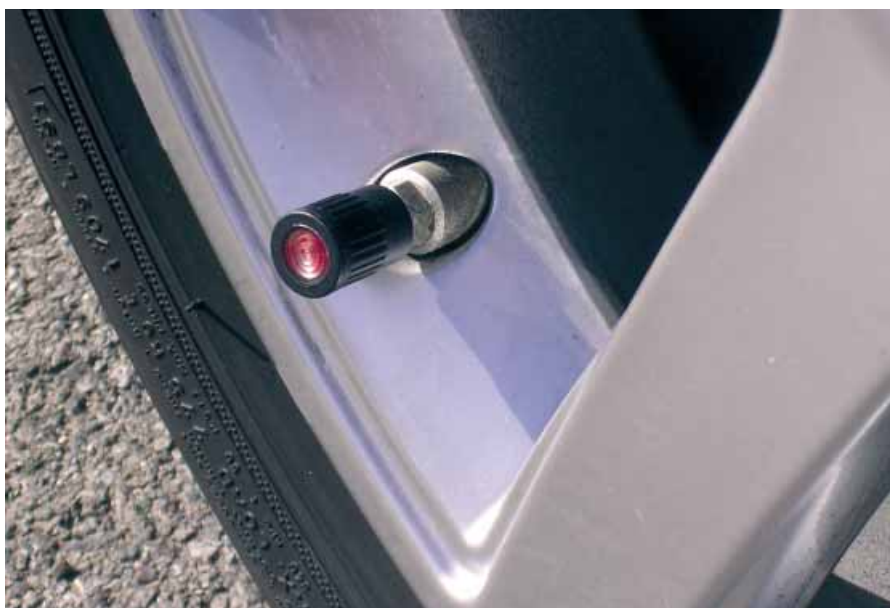
Den XPO-Sensor bringt Pirelli im Frühjahr auf den Markt. Das sehr einfach montierbare Reifendruckkontrollsystem ist in der Ventilkappe integriert
